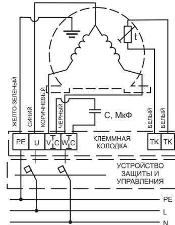
Схема подключения трехфазного электродвигателя вентиляторов -4D; -6D; -8D с частотным регулятором мощностью от 4 кВт (кроме VR 90-50/45.4D). Питание 380В.
