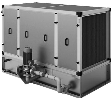
Форсуночный увлажнитель предназначен для адиабатического увлажнения воздуха. Высокая эффективность (КПД до 95%) обеспечивается встречным распылением воды двумя рядами форсунок (один ряд по потоку воздуха, второй ряд - против потока воздуха).
