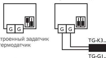
Внешний дополнительный термодатчик и потенциометром TBI... в качестве задатчика
