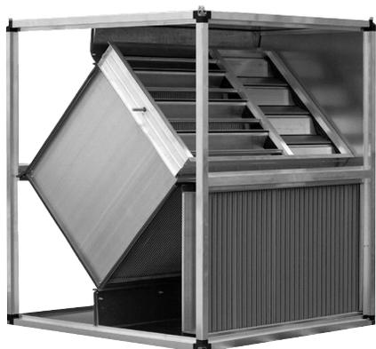
Пластинчатый рекуператор предназначен для утилизации тепловой энергии вытяжного воздуха. Передача теплоты происходит от тёплого воздуха к более холодному через твёрдую стенку, разделяющую 2 потока воздуха. Поверхность теплообмена рекуператора образована пакетом алюминиевых пластин, между которыми происходит перекрёстное движение приточного и вытяжного воздуха. КПД рекуперации достигает 70%.
