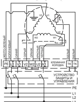
Схема подключения однофазного электродвигателя вентиляторов -4Е. Питание 220В.
