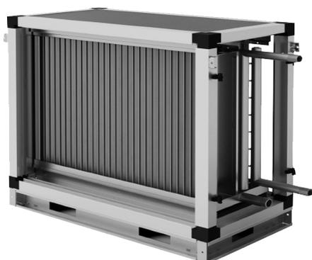
Водяной охладитель предназначен для охлаждения приточного воздуха. Теплообменник состоит из медных трубок, оребренных алюминиевыми пластинами. Все секции оснащены профильным пластиковым каплеуловителем и поддоном с патрубком для сбора и отвода конденсата. Теплообменник с поддоном и каплеуловителем расположен на специальных направляющих, что позволяет легко извлекать его из корпуса для обслуживания и ремонта.
