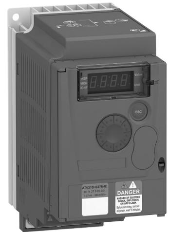
Благодаря инновационной схеме распределения потоков охлаждающего воздуха и усиленному покрытию плат, серия может использоваться в самых агрессивных условиях эксплуатации. Допускается работа при температуре воздуха вокруг преобразователя частоты до 55 °С без корректировки его технических характеристик. При превышении температуры следует применять кривые снижения выходного тока, приведенные в Руководстве пользователя. Степень защиты IP 20 (IP 41 в верхней части преобразователя частоты).
