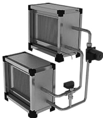
Секции рекуператора с промежуточным теплоносителем применяются при условии полного разделения воздушных потоков и больших расстояниях между приточной и вытяжной системами. Эффективность устройства данного типа до 50%. Теплоносителем являются водные растворы гликоля различных концентраций. Теплообмен регулируется путем изменения расхода теплоносителя, с помощью трехходового клапана, установленного в контуре теплоносителя.
