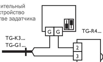
Внешний термодатчик и встроенный задатчик
