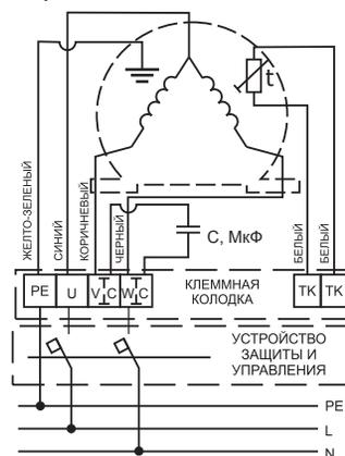
Схема подключения трехфазного электродвигателя вентиляторов -4D; -6D и -8D с частотным регулятором мощностью до 4кВт. Питание 220В.
