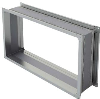
Гибкие вставки применяются для исключения передачи вибрации на сеть воздуховодов, компенсации несовпадения осей воздуховодов и установки. Фланцы гибкой вставки изготовлены из оцинкованной стали и соединены прочным и эластичным виниловым материалом, исключающим утечки при длительном сроке эксплуатации.
