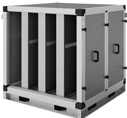
Шумоглушитель применяется для снижения уровня шума в канале от вентиляционного агрегата. Конструкция шумоглушителя представляет собой короб, собранный из кассет, с установленными внутри плитами из звукопоглощающего материала.
